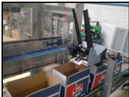
V 710BC défilage sur tapis à la volée : Cyclé par détection d'objet en mouvement
