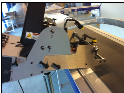
V 710BC défilage sur tapis à la volée : Cyclé par détection d'objet en mouvement. Modèle V710BC avec option extension de 30cm par courroies
